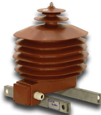
Fas till jord, epoxiisolerad spännintransformator 30/0.11kV
